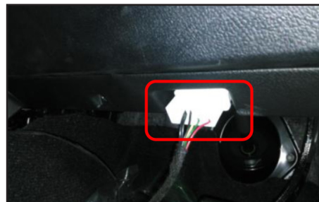
Raccordez l'OBD comme sur l'image ci-dessus
