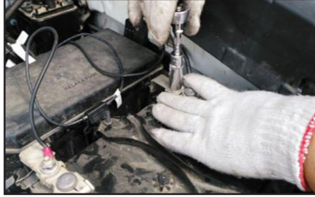
Raccordez le faisceau à la batterie : le rouge avec le fusible est positif.
