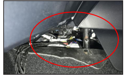
Collez l'ECU ici avec un ruban 3M
