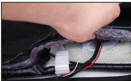
La ligne de moteur à partir de la position ci-dessus pour aller sur le châssis
