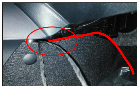
Insérez le câble de moteur droit et la ligne OBD de cette position vers le côté passager.
